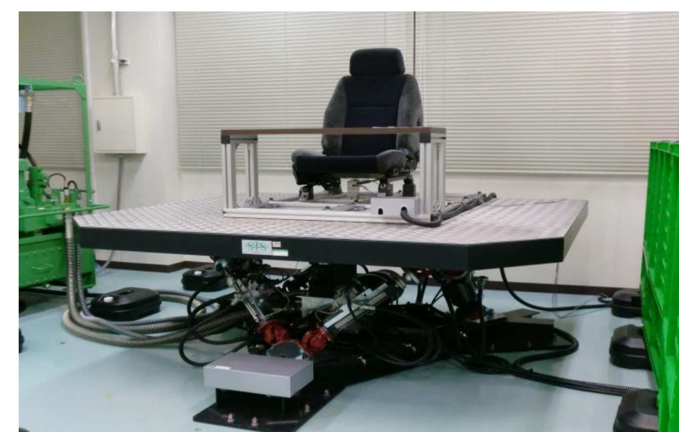
3次元6自由度加振装置によるドライビングシミュレータ
