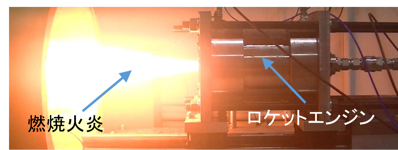
卒論生が設計・製造したロケットエンジン燃焼実験
