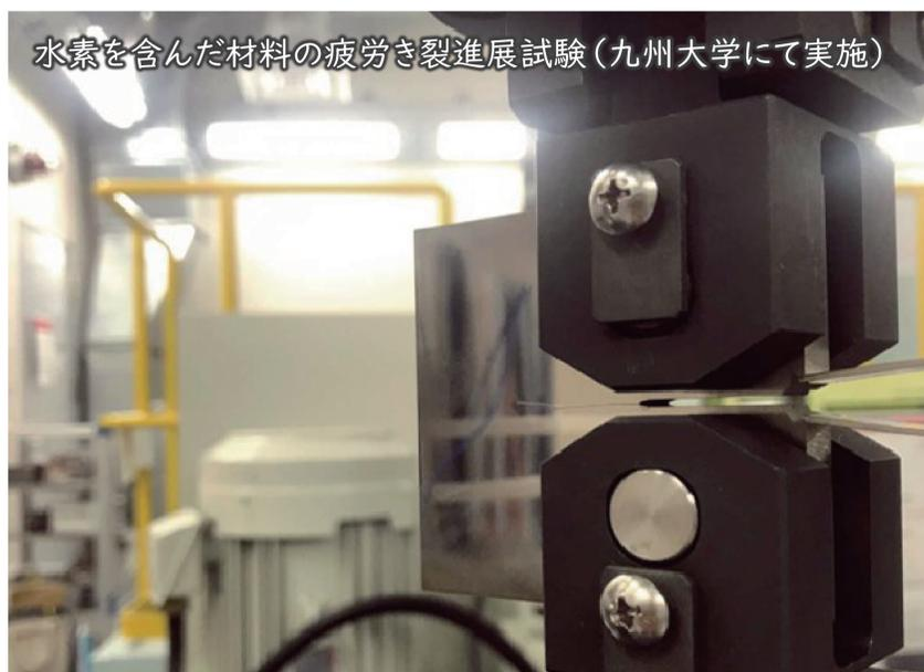
水素を含んだ材料の疲労き裂進展試験（九州大学にて実施）
